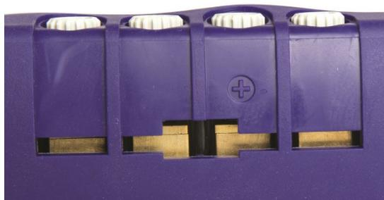
Ce système unique de connexion s'utilise en pressant sur le dessus de la borne et en insérant les fils (jusqu'à 3 mm ou 10 AWG de diamètre) et fiches thermocouples compensées miniatures puis en relâchant la pression.
